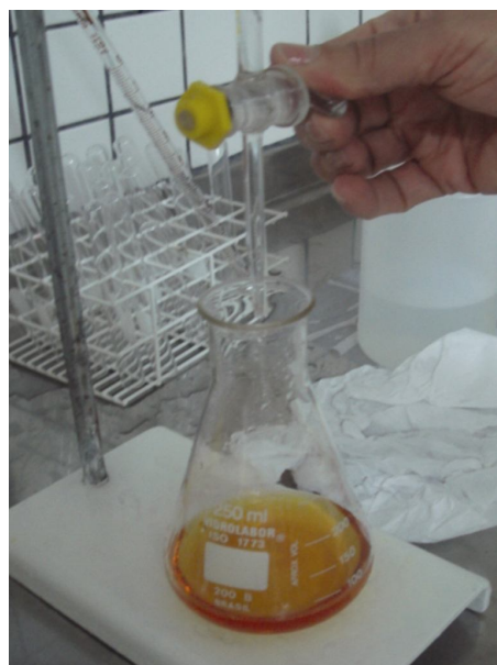
Figura 9 – Gotejamento de Tiosulfato de Sódio 0,1N
