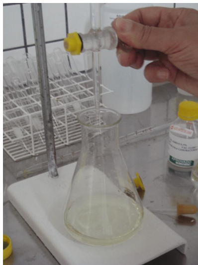
Figura 11 – Coloração incolor resultante da titulometria
