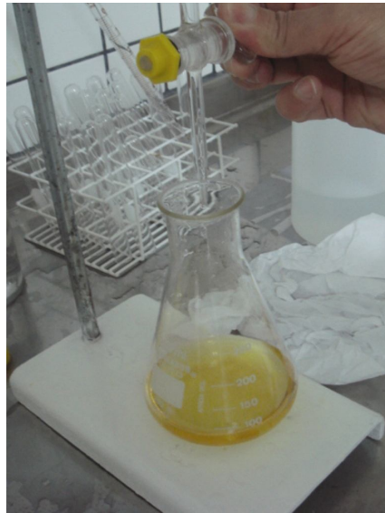
Figura 10 – Mudança de cor causada pelo processo de titulação
